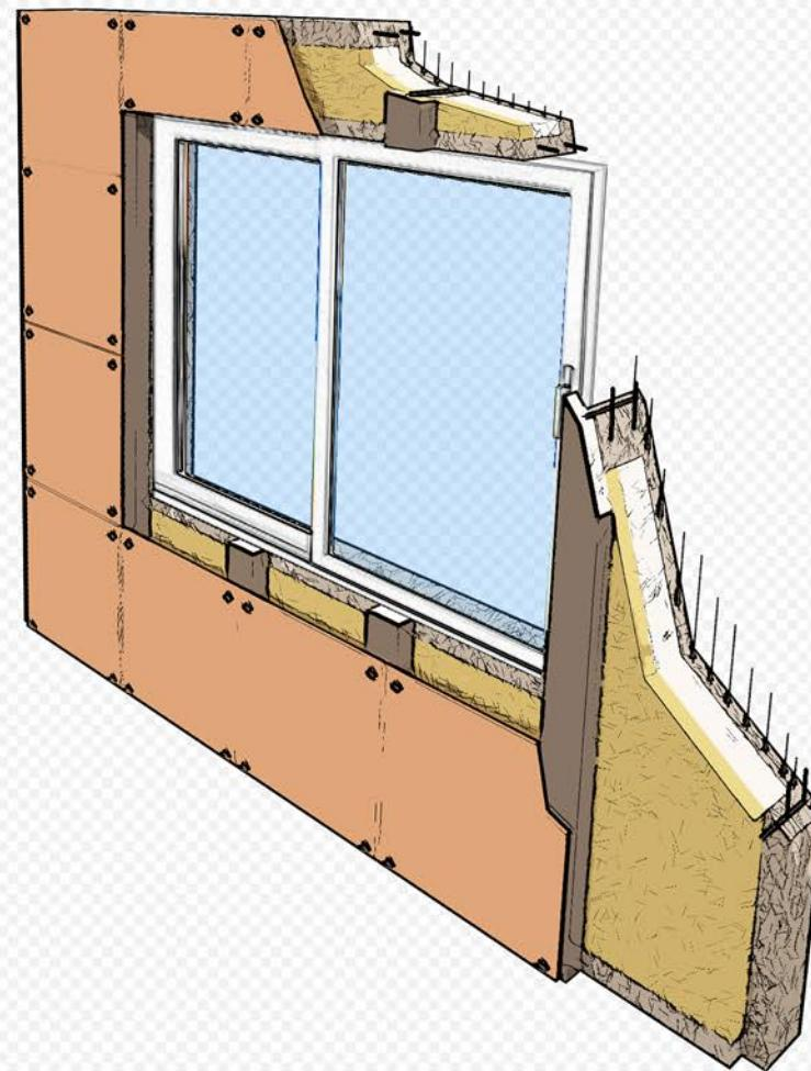
Стеновые панели БЭНПАН+ с предустановленными в заводских условиях утеплителем и подсистемой вентилируемого фасада и опционально окном откосами и отливами предназначены для применения в качестве ограждающих конструкций многоэтажных зданий из монолитного и сборного железобетона высотой 75 метров и более.
